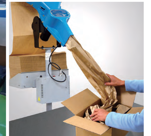
Ranpak社の紙緩衝材システム。プラスチック系緩衝材に比べ、ランダムな隙間埋め作業をスピーディーに行うことができる
